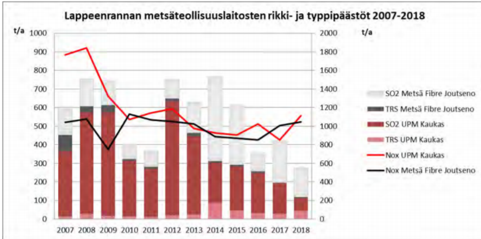
Kuva 4: Lappeenrannan tehtaiden TRS-, SO 2 - ja NO x - päästöt (t/a) vuosina 2007 - 2018 (Pylväsdiagrammien asteikko vasemmalla ja viivadiagrammien asteikko oikealla)
