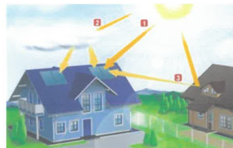
Slnečné žiarenie: 1. Príame: dopadá za jasnej oblohy na plochu 2. Rozptýlené-difúzne: vzniká rozptýlením priameho žiarenia na oblakoch a nečistotách v atmosfére. 3. Odrazené: od zemského povrchu a iných objektov
