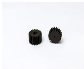
Zobnik natisnjen s tiskalnikom MakerBot Replicator+
