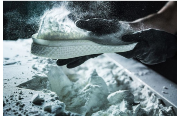
Figura 10: Sagoma di scarpa realizzata con SLS [21]
