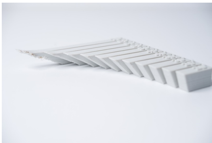
Figure 51: Effetto di un aumento dell'angolo di sbalzo (incremento di 5 gradi) sulla qualità di stampa. L'ampiezza massima raffigurata è di 70 gradi [73]
