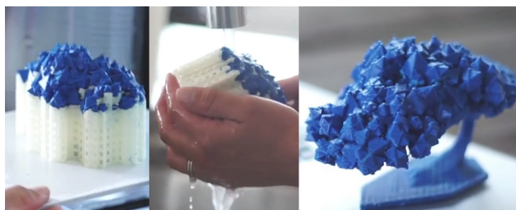
Figura 18: Rimozione dei supporti in materiale solubile tramite immersione. [49]
