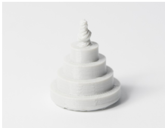
Figura 53: Prototipo di perno cilindrico filettato con diametro decrescente (da 25 a 5mm) con estremità superiore troppo piccola per la stampa. [75]
