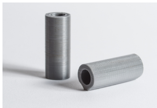
Figura 9: Qualità diverse di uno stesso oggetto dovute a orientamenti diversi. [38]
