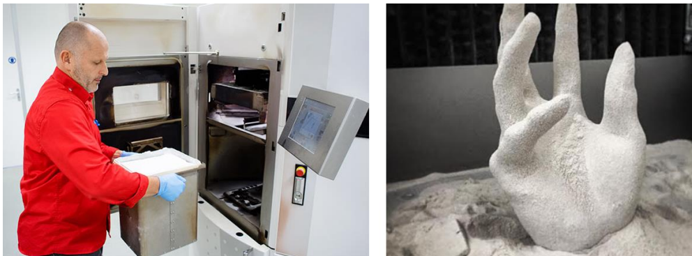
Figura 34: Proceso de extracción para SLS. [46]
