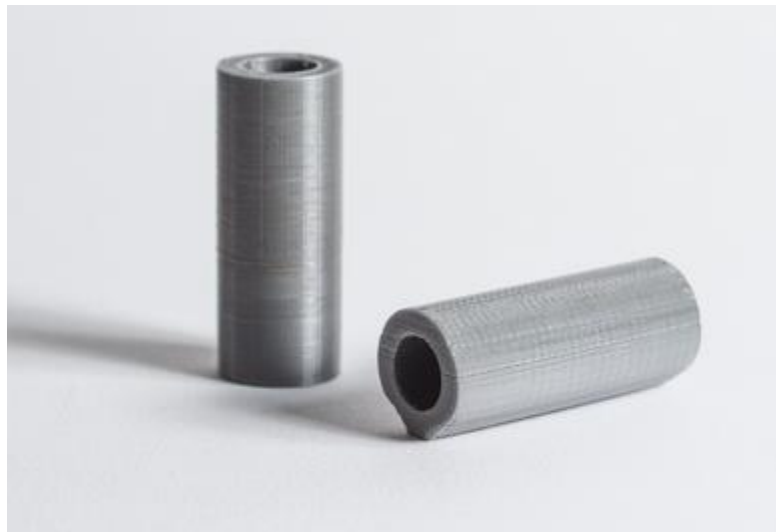
Figura 26: Diferencias de calidad en una misma pieza, dependiendo de su orientación. [38]
