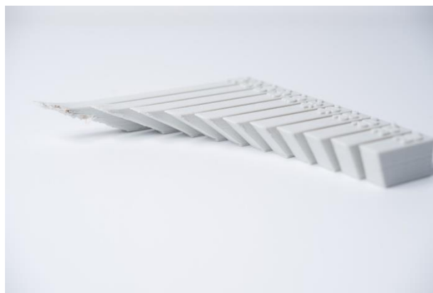
Figura 51: El efecto de incrementar el ángulo de voladizo (incrementos de 5 grados) en la calidad de impresión. El ángulo máximo mostrado es de 70 grados. [73]
