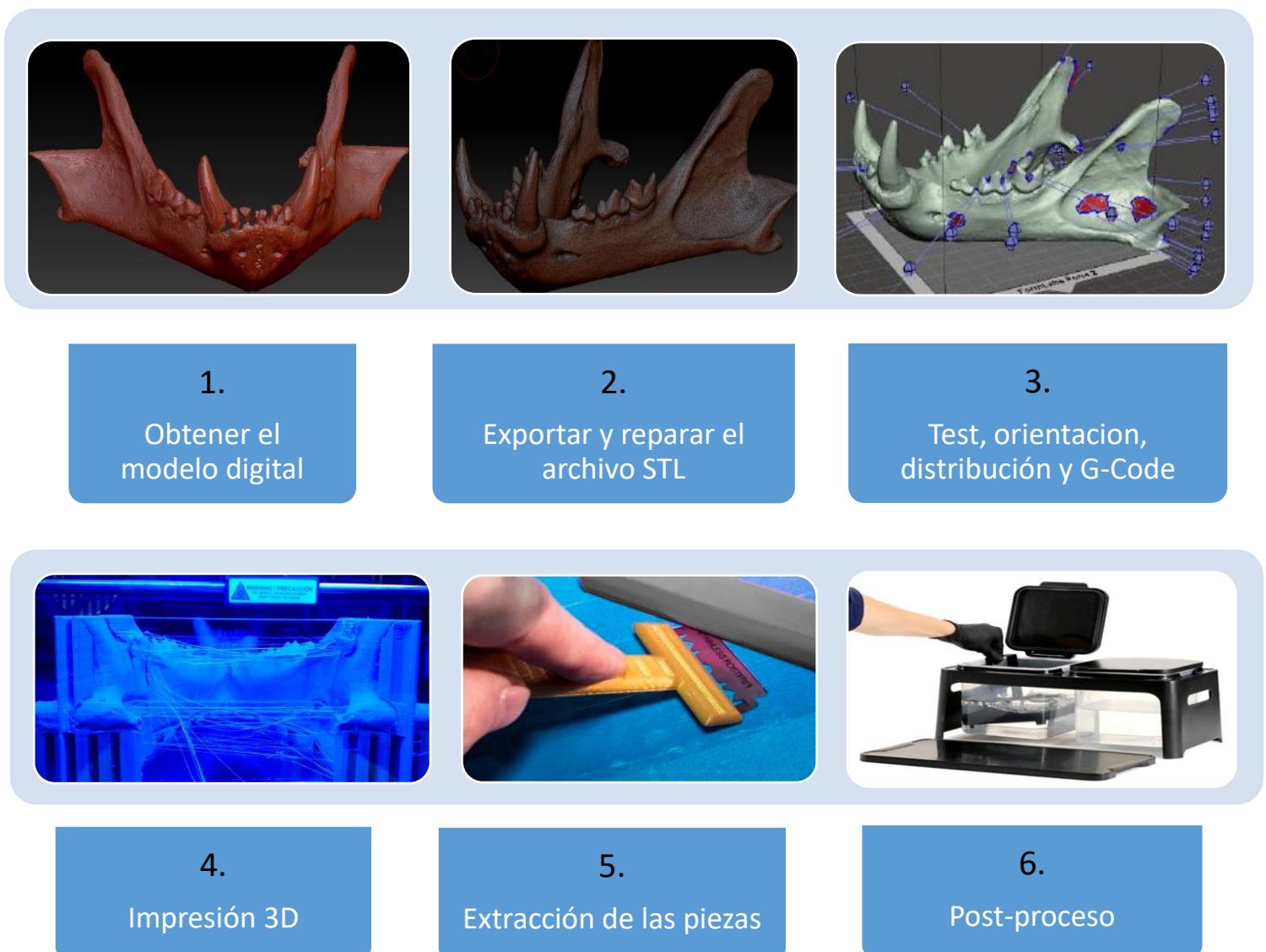
Esquema 2: Proceso de producción en impresión 3D [25]
