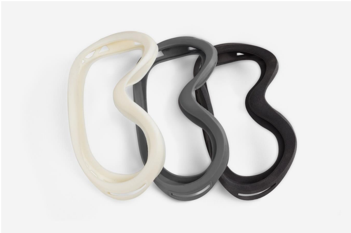
Figura 5: Prototipos del marco de unas gafas de ski impresas por FDM, SLA y SLS (de izquierda a derecha) [8]
