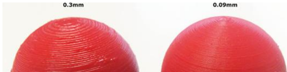
Figura 29: Dos alturas de capa distintas. [41]
