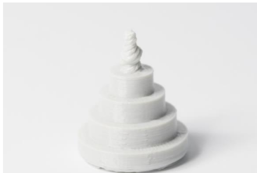
Figura 53: Impresión de pines verticales disminuyendo el diámetro (de 25 a 5 mm), mostrando que el diámetro superior de la impresión se vuelve muy pequeño para imprimir con precisión. [75]
