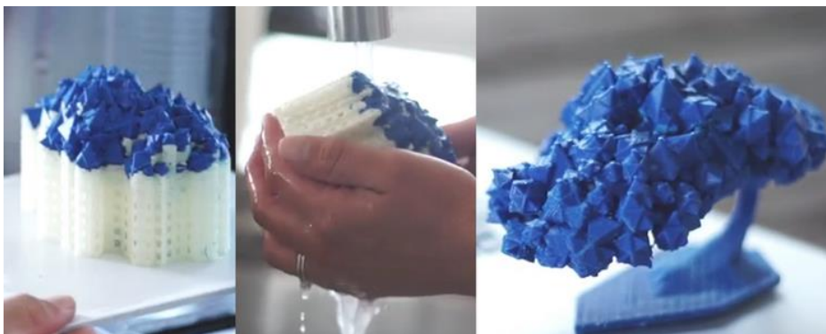
Figura 37: Baño para quitar las estructuras de soporte. [49]
