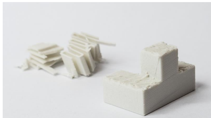
Figura 49: Pieza de puzle impresa por FDM con los soportes retirados, mostrando la aspereza de la superficie. [71]
