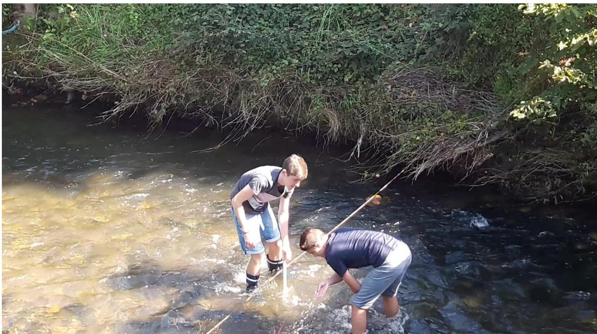
Ausmessung des Querprofils
