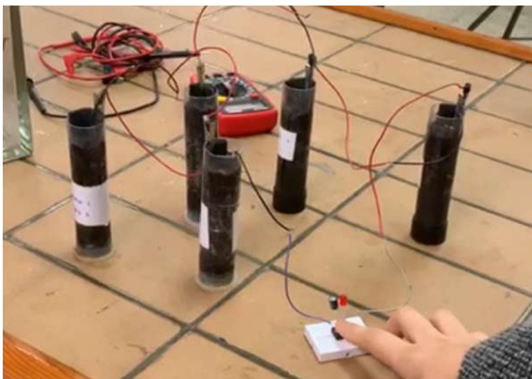
Imagen del circuito eléctrico montado a partir de celdas de los diferentes sustratos.
