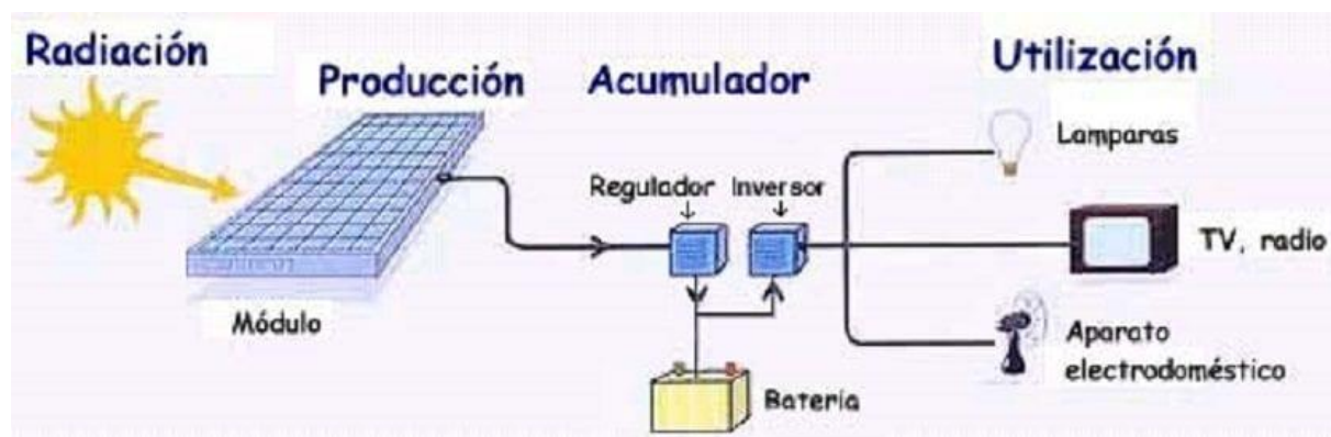
1.3 Esquema obtenció d'energia de plaques solars.
