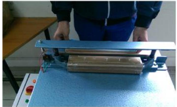
Drveni predložak postavim na stroj za varenje plastičnih vrećica.
