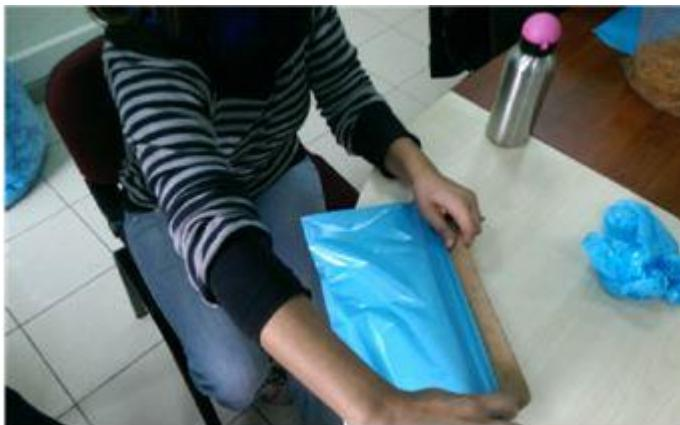
Skidam gotovu navlaku za cipele s drvenog predloška.
