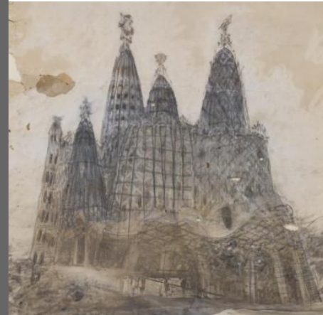
Ilustración 27. Reproducción de la maqueta funicular de la iglesia de la Colonia Güell usada por Gaudí expuesta en Museo del Templo de la Sagrada Familia, 2016. Imagen propia.
