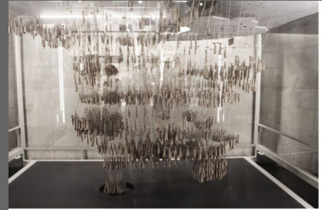
Ilustración 27. Reproducción de la maqueta funicular de la iglesia de la Colonia Güell usada por Gaudí expuesta en Museo del Templo de la Sagrada Familia, 2016. Imagen propia.
